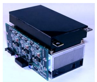
60 kW/L 丰田碳化硅控制器
