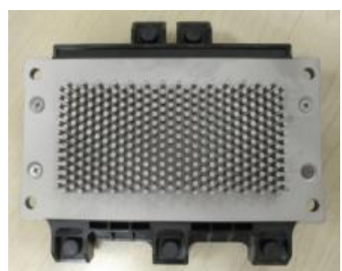
三相1200V/300A SiC 平面型模块及散热
