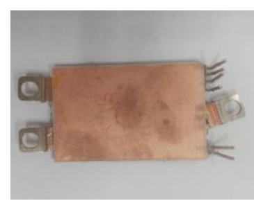
单相1200V/400A SiC 平面型模块及散热
