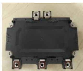
三相1200V/300A SiC 平面型模块及散热
