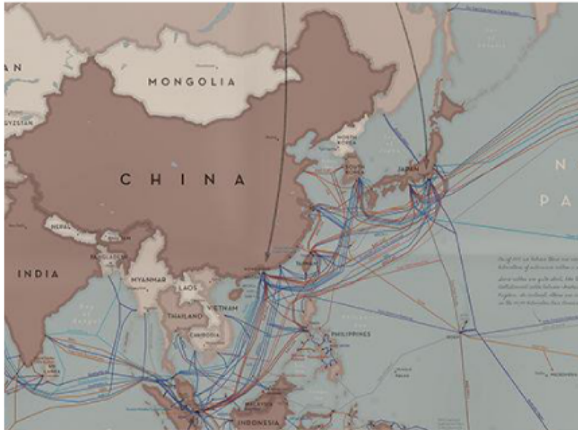
图 89：我国周围海域海底电缆敷设情况（2017）
