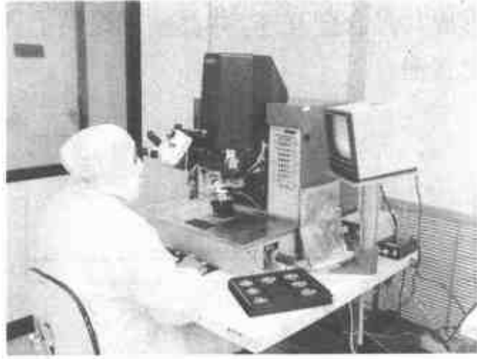
芯片到引线框架的引线键合 (承蒙 Austin 半导体有限公司允许使用照片)
