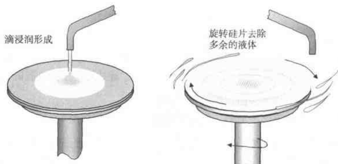
图13.14 HMDS滴浸润液和旋转
