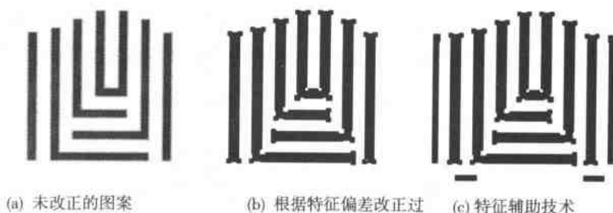
图 14.45 衬线用来减小接触角变圆
