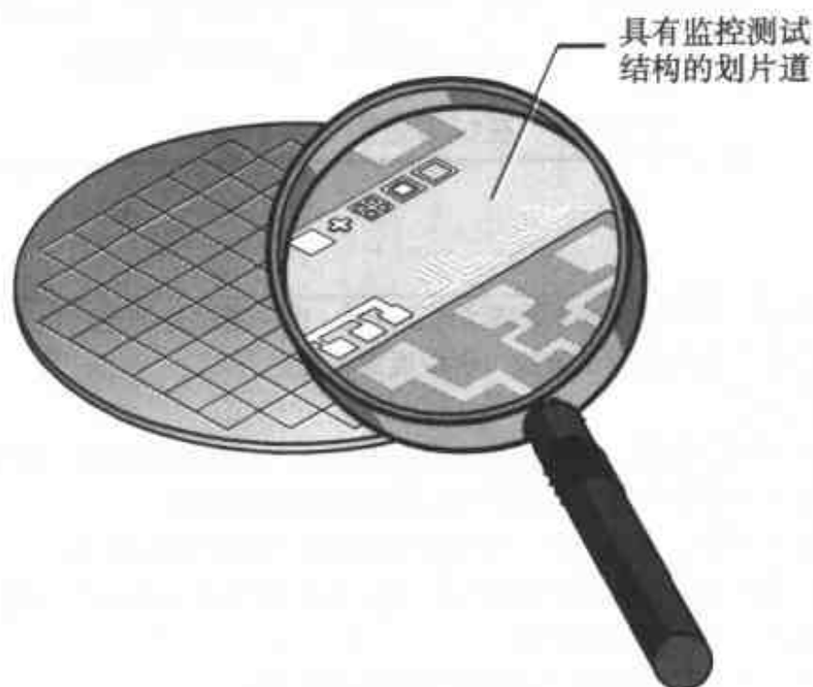
图 19.3 划片道监控测试结构
