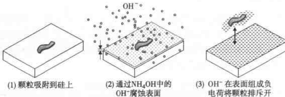
图 6.27 颗粒通过负电荷排斥而去除
