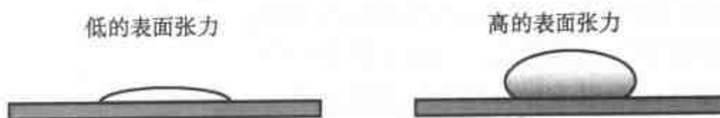
图 5.10 液体在硅片上的表面张力
