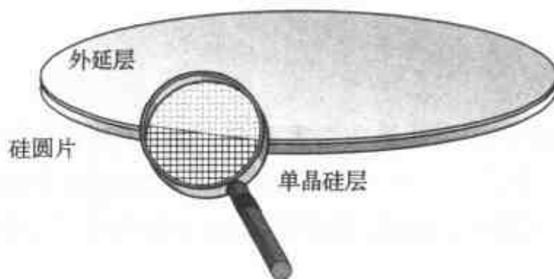
图 4.29 硅外延层的结构
