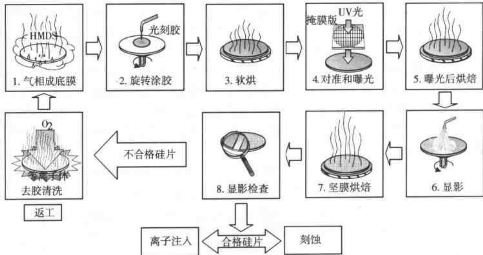
图 15.9 显影检查的返工流程
