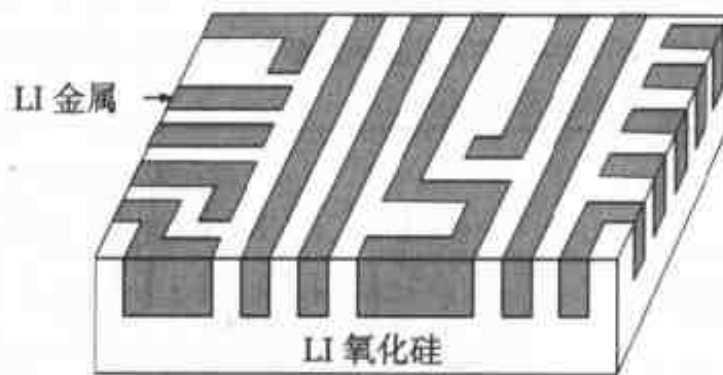
图 9.20 作为嵌入 LI 金属的介质的 LI 氧化硅
