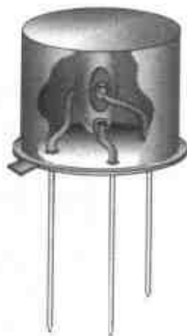
图 20.14 TO型金属封装
