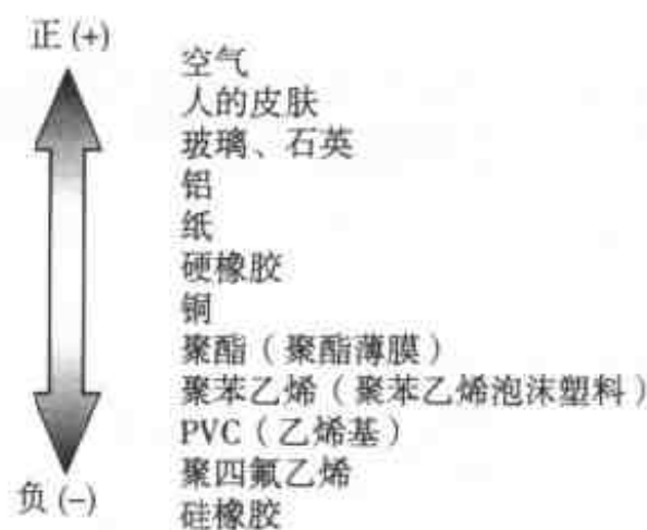
图 B.1 普通材料产生电荷能力
