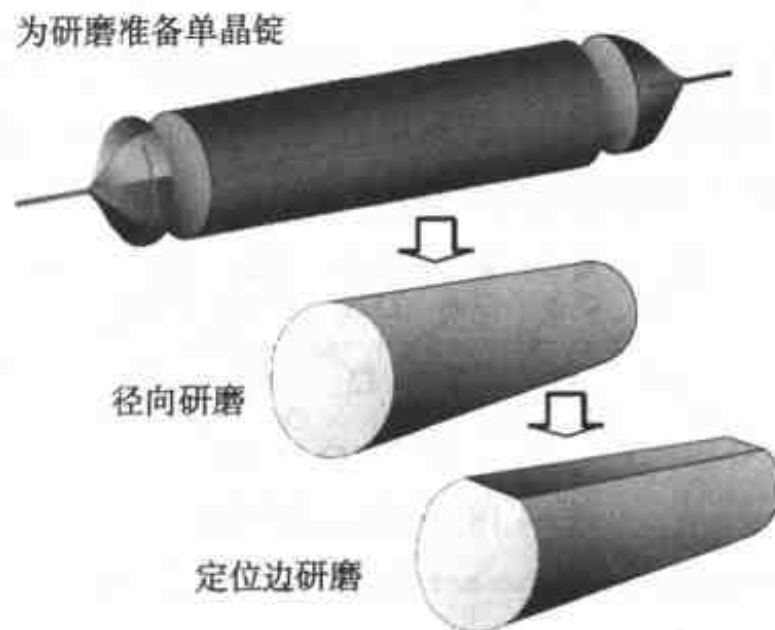
图 4.20 硅锭径向研磨
