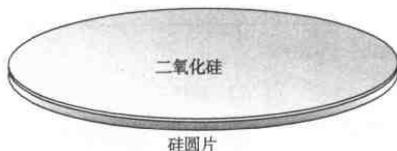
图 2.20 硅圆片上的 \text{SiO}_2
